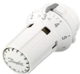
Термостатический вентиль состоит из двух основных частей – вентиля и термостата. Термостат – это регулятор собственного действия. Внутри термостата содержится вещество, объем которого изменяется в зависимости от температуры окружающего воздуха.
